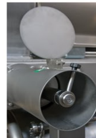
Dettaglio della coclea per l'evacuazione degli scarti
