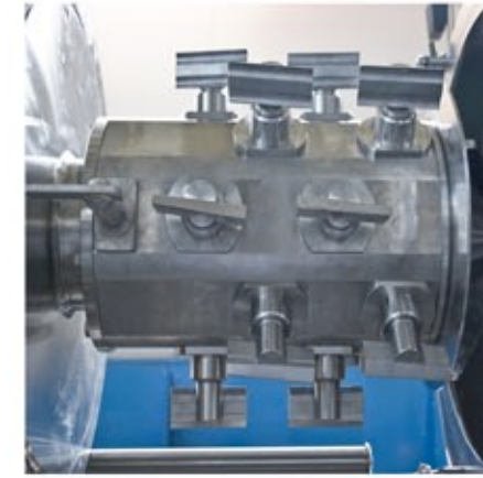
Il rotore a pale regolabili, in posizione di macchina aperta
