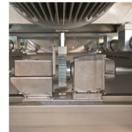
Trasmissione "pignone-cremagliera" ad azionamento manuale mediante manovella, per l'estrazione del rotore dal corpo macchina
