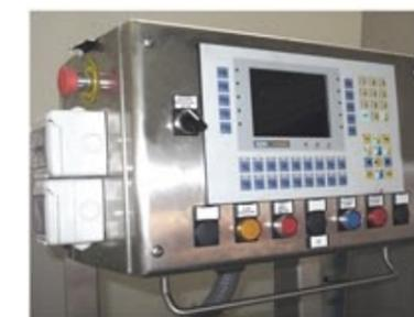
Il PLC per la gestione di tutte le fasi di riempimento, del controllo dei parametri di funzionamento e sistema di autodiagnosi
