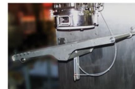
Dispositivo per il riempimento di sacchi aseptici da 1 a 25 litri "bag in box"
