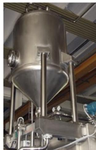
Tank aseptico di stoccaggio (accessorio), e il flussometro elettromagnetico per la misurazione della portata
