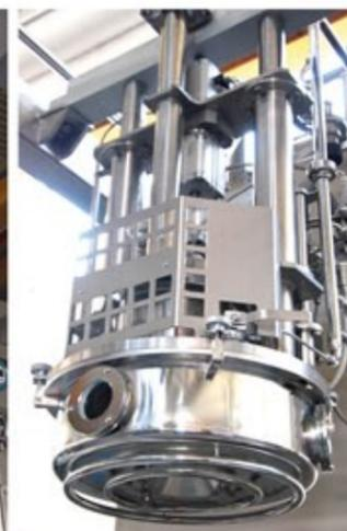
Dettaglio della testa di riempimento, configurata per sacchi da 1 a 220 litri
