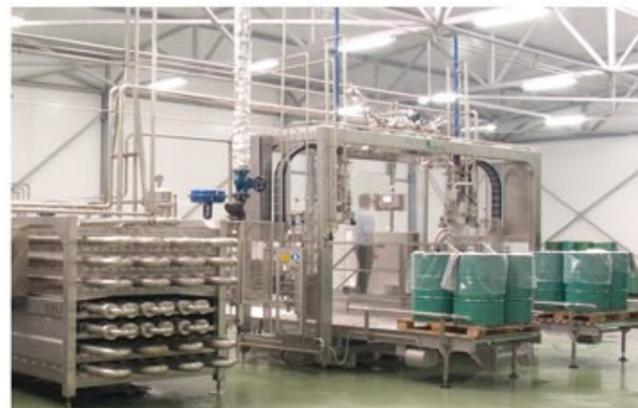
Riempitrice mod. USA 152 attrezzata per sacchi da 220 litri in fusti su pallet. Dettaglio d'insieme completo di uno sterilizzatore a tubi concentrici di costruzione "BOEMA"
